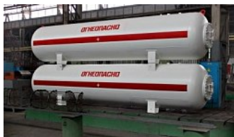
Сосуд для сжиженных газов (СУГ) 5 м 3
