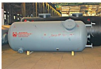
Ресиверы воздуха объемом 8 м 3
