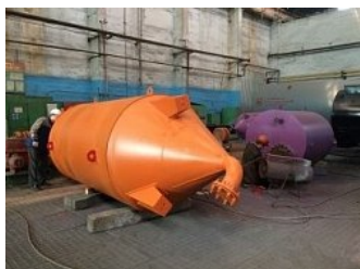
Мерники едкого натра объемом 3,2 м 3
