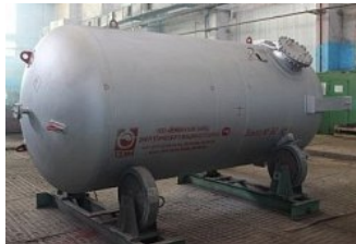
Резервуар сжатого воздуха объемом 10 м 3 >
