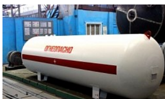
Сосуд для сжиженных газов (СУГ) 10 м 3
