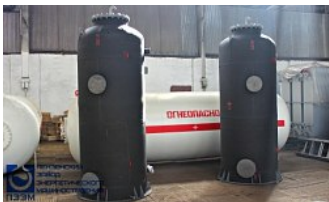
Емкость для хранения этиленгликоля АЕ-2-0,05 >
