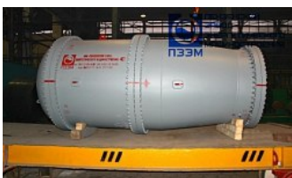
Сосуд ускорителя электронов ЭЛВ-8 для РАН
