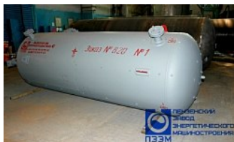
Аппарат емкостной Р-4,0-1,0-09Г2С
