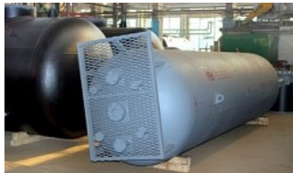
Ресивер азота объемом 10 м 3
