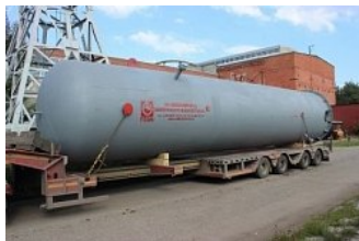
Ресиверы водорода объемом 63 м 3
