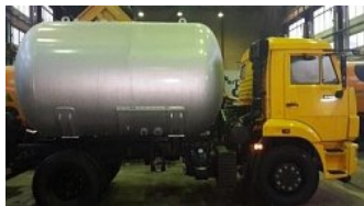
Емкость горизонтальная для СУГ объемом 11,3 м 3
