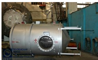
Аппарат емкостной ВКК-2-0,05 из нержавеющей стали >
