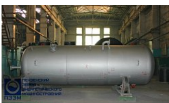
Ресивер воздуха P-10-1,1-12X18H10T из нержавеющей стали >
