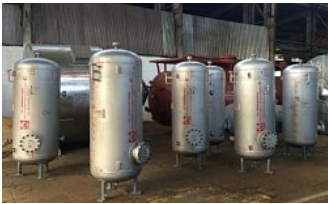
Ресиверы азота объемом 0,9 м 3
