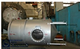
Аппарат емкостной ВКК-2-0,05 из нержавеющей стали >
