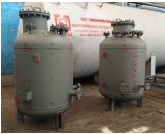
Емкости вертикальные ВЭЭ объемом 1 \text{ м}^3 >
