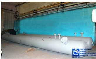
Конденсатороборник объемом 5 м3
