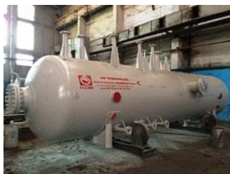
Аппарат емкостной объемом 28 м 3
