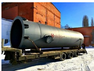
Ресиверы водорода объемом 30 м 3
