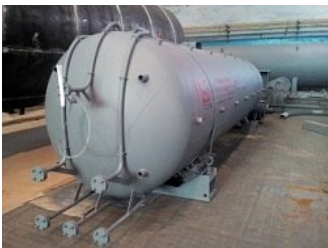
Резервуар для хранения жидкой двуокиси углерода РДХ-12,5-2,0 >
