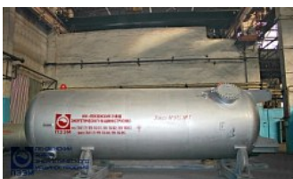
Ресивер азота Р-20-1,6 объемом 20 м3 из нержавеющей стали
