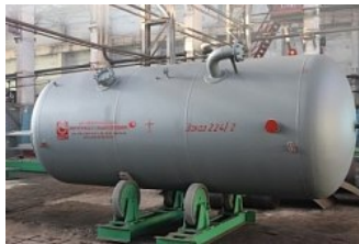
Ресиверы воздуха объемом 16 \text{ м}^3 >
