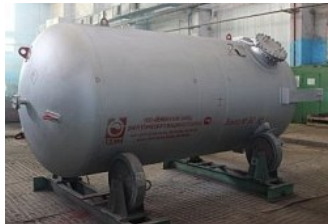
Резервуар сжатого воздуха объемом 10 \text{ м}^3 >
