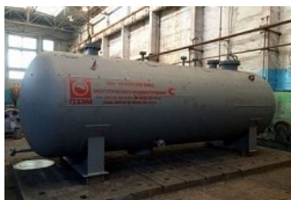
Емкость-отстойник бензина объемом 20 м 3
