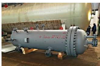
Газосепаратор сетчатый ГС-1-6,3- 800-2-И
