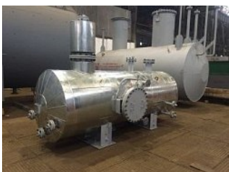
Нефтегазовый сепаратор объемом 2,5 м 3
