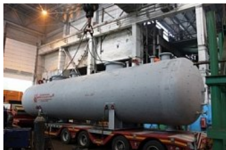
Отстойник воды ОВ-50 >
