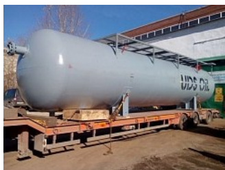
Нефтегазовый сепаратор объемом 50 м 3 >
