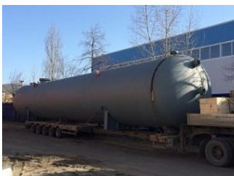
Нефтегазовый сепаратор объемом 200 м 3 >
