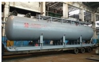
Нефтегазовый сепаратор на санях объемом 50 м 3
