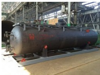
Нефтегазовый сепаратор со сбросом воды на санях объемом 12,5 м 3 >
