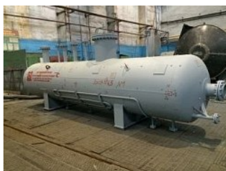
Факельный сепаратор объемом 6,3 м 3
