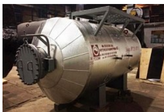
Сепаратор концевой ступени объемом 3,5 м 3
