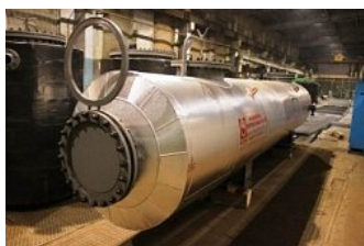
Факельный сепаратор объемом 4 м 3
