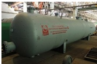
Нефтегазовый сепаратор со сбросом воды объемом 50 м 3 >
